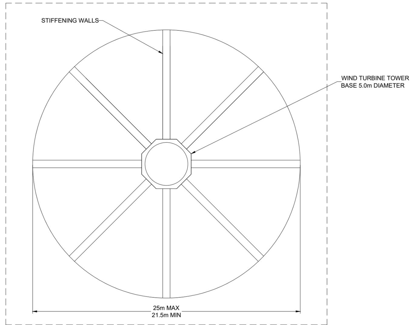
**TYPICAL TURBINE FOUNDATION LAYOUT PLAN**
